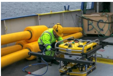
Abbildung: Inspection Class ROV mit Magnetometer der Firma Sensys GmbH
