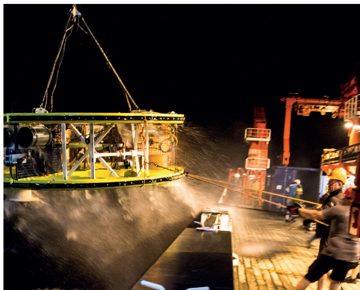
Abb.3: Einsatz des Multisensor-Systems Golden Eye der BGR zur Messung von elektrischen und magnetischen Eigenschaften des Meeresbodens von Bord des Forschungsschiffes „Sonne“ in 2019 (© BGR).
