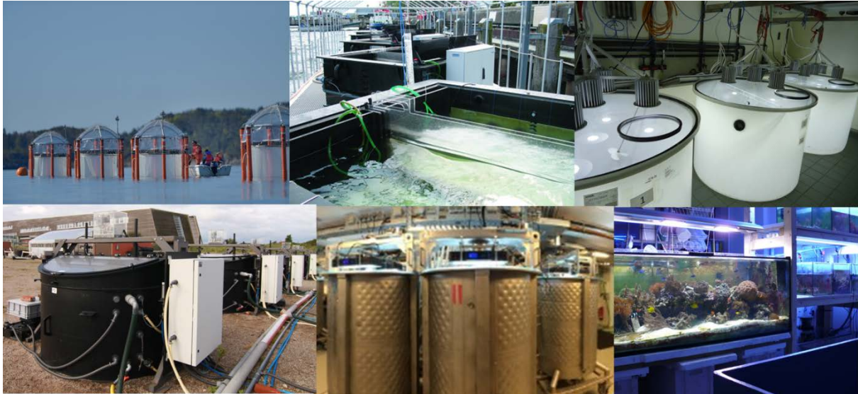
Abb. 4: Einige Experimentalanlagen für die marine Biodiversitätsforschung. oben links) Plankton Mesokosmen des GEOMARs ( www.bioacid.de ); oben mitte) Benthische Mesokosmen am GEOMAR ( www.geomar.de ); oben rechts) Indoor Mesokosmen (1300L) des GEOMAR. unten links) Mesokosmenanlage des AWI auf Sylt. unten mitte) Plankotronanlage des ICBM in Wilhelmshaven (12 Behälter zu 600L, www.planktotrons.de ); unten rechts) Aquarienanlage U Giessen.
